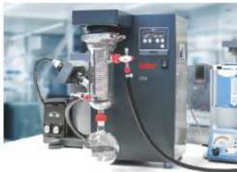
LA TRAPPOLA FREDDA CT50 PER IL RECUPERO SOLVENTI IN LABORATORIO
